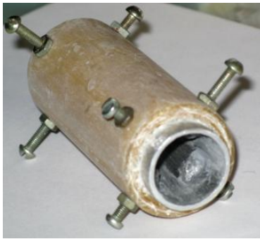
Фото.8 Втулка “2” с намоткой “14” после приклеивания гаек “18”.
