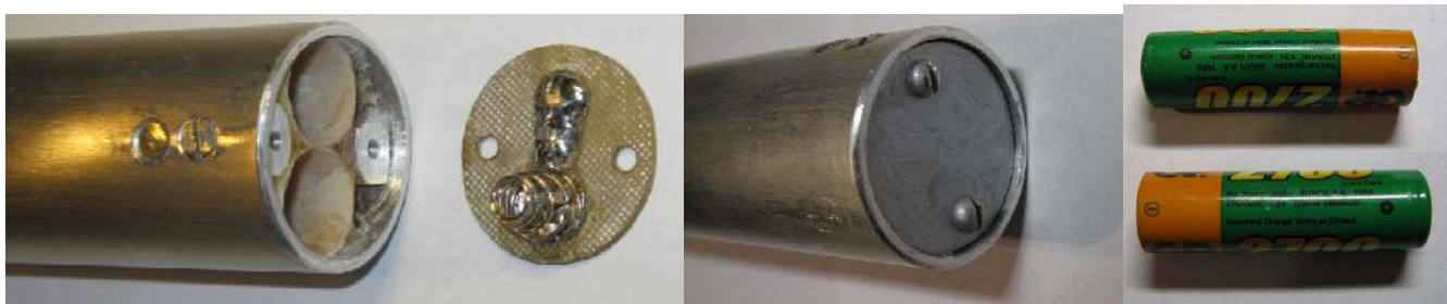
Фото.11 Задний конец эфеса с отсоединённой и присоединённой крышкой “7” аккумуляторного отсека и аккумуляторы (2 из 6-ти).
