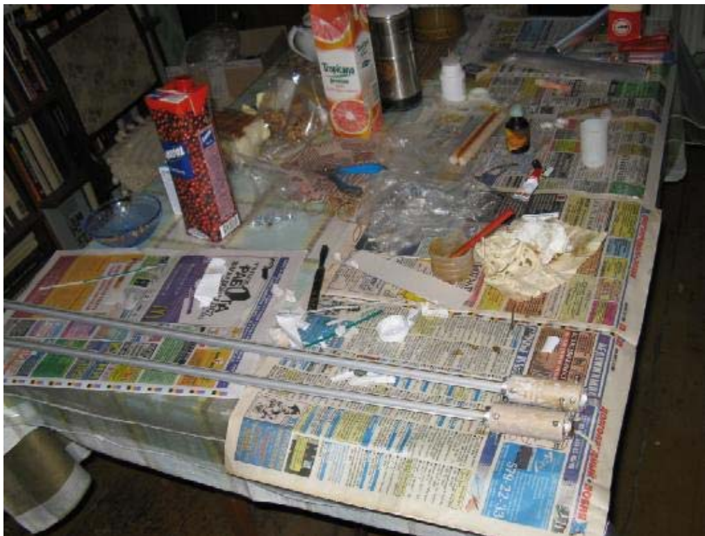
Фото.24 Рабочий момент. Стол (он же обеденный) после заливки эпоксидной смолы внутрь втулок “2” рис.6 и склеивания эпоксидной смолой вместе друг с другом трубок контейнера аккумуляторов. На переднем плане два лезвия – рапиры, приклеивающиеся к втулкам “2”.
