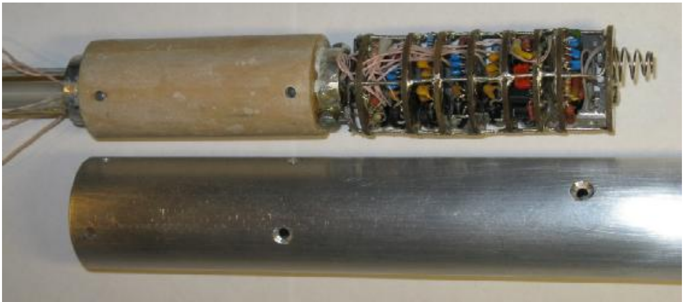
Фото.23 Световой меч во время сборки (перед установкой втулки “2” с лезвием, намоткой “14” и электронными патами в рукоятку).
