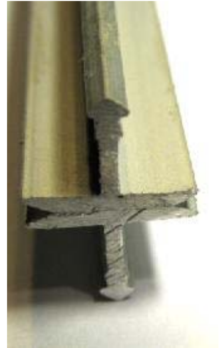
Рис.7 Схема крепления лезвия и гарды светового меча к трубке - корпусу эфеса. Справа показана фотография среза двух "Т" - образных дюралюминиевых профилей, образующих лезвие – рапиру. Высота "Т" – образного профиля – 9 мм, ширина – 13 мм.
