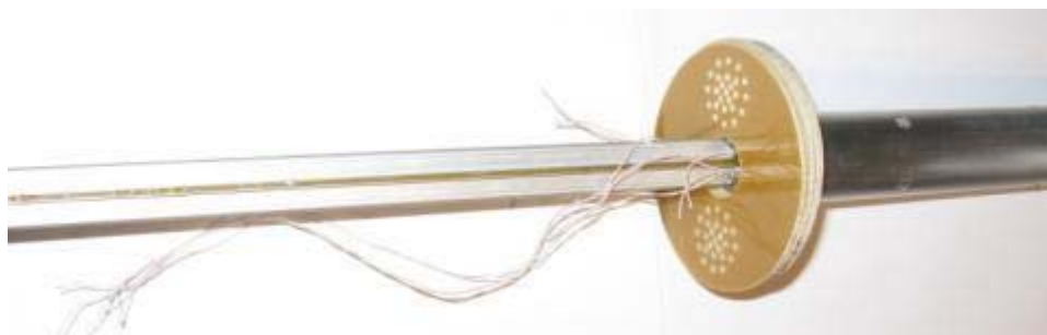
Фото.25 Момент сборки светового меча. Примерка частей гарды на собранный эфес с лезвием (внутри эфеса - электронные схемы).
