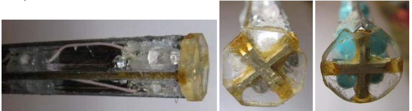
Фото.13 Вид конца лезвия с кружком из оргстекла, приклеенным к дюралюминиевой рапире для красного (слева) и синего (справа) меча. (Показан вид без оболочки и наконечника из пенополиэтилена.)
