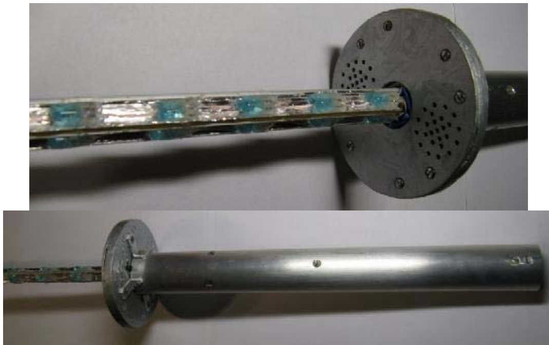
Фото.28 Момент сборки синего светового меча. Меч перед обмоткой лезвия защитным слоем из пенополиэтилена.
