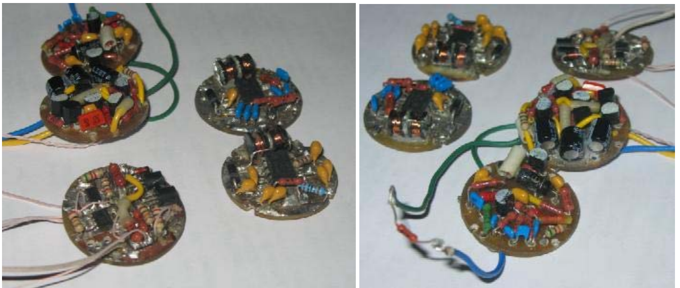
Фото.18 Платы электронных блоков синего светового меча (во время наладки).
