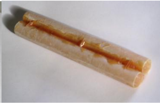
Фото.9 Контейнер для аккумуляторов “5”. Трубки изготовлены путём намотки бумаги, пропитанной эпоксидной смолой.
